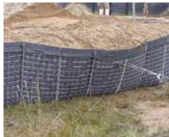
一体性比較実験状況
